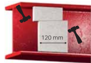
Montering av kil
